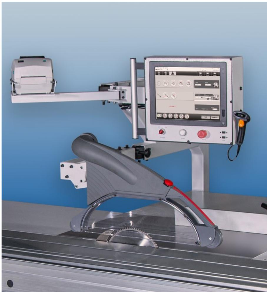
**Nella versione OPTI, il computer industriale touch screen basato su sistema operativo Windows garantisce un funzionamento affidabile del sistema CNC e l'ottimizzazione dell'intero processo di lavoro. Un secondo schermo è posizionato sul retro della macchina.**
