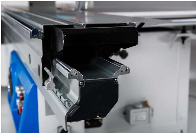
**il carro di scorrimento** si muove su grandi rulli doppi che tengono il tavolo superiore in collegamento con il sottocarro con assoluta precisione nelle rispettive guide tonde.
