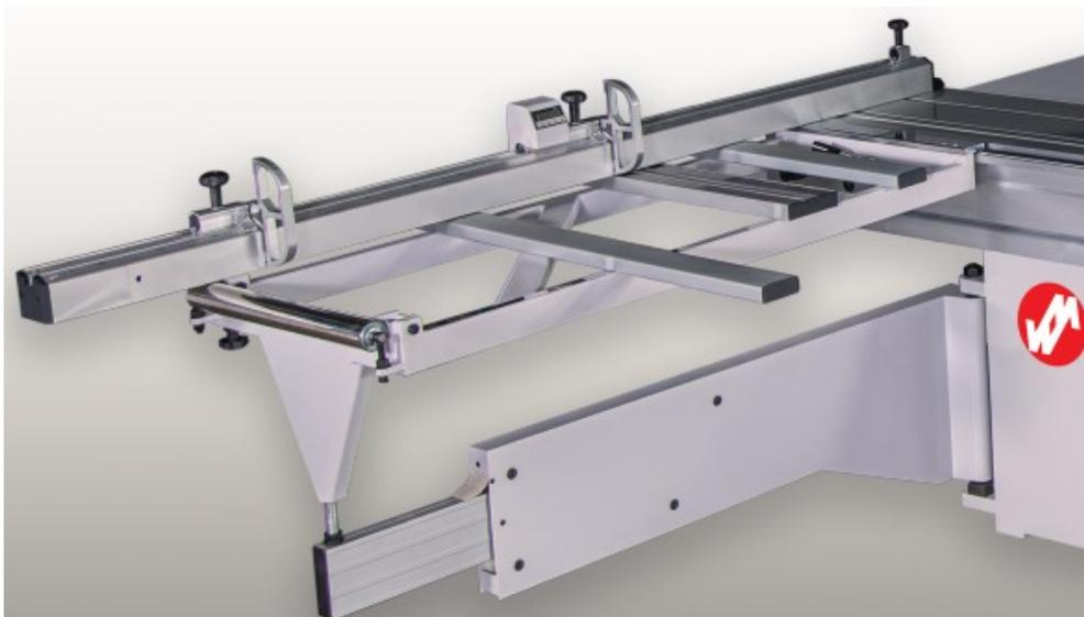
La slitta trasversale fissa a **90 gradi** consente il taglio preciso di pannelli di diverse dimensioni. Il **registro telescopico** può essere facilmente spostato per effettuare **tagli inclinati**. È fornito di due stop ribaltabili di cui uno con display di misurazione digitale decimale.
