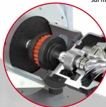
▼ Sistema di trasmissione con **ingranaggi** previsto sui modelli 76 - 90.
