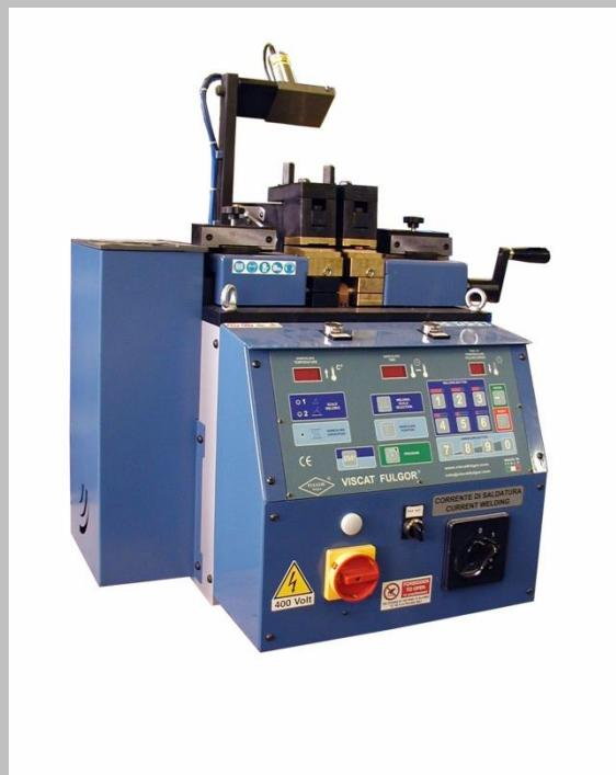
Saldatrice di testa a scintillio. Completamente a controllo elettronico è automatica sia in fase di saldatura che in quella di rinvenimento. Ciclo di rinvenimento controllato da pirometrico ottico con puntatore laser che permette una precisa rilevazione della temperatura di rinvenimento. Rinnovata in molti sui aspetti, e in modo particolare nel gruppo morse, può sopportare alti carichi di lavoro. Cesoia compresa.
