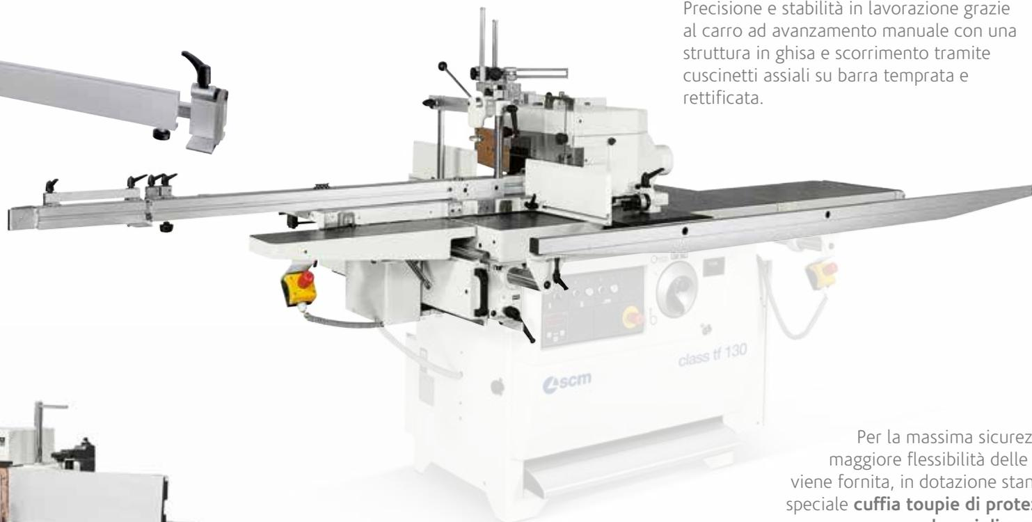
Per la massima sicurezza ed una maggiore flessibilità delle macchine viene fornita, in dotazione standard, una speciale **cuffia toupie di protezione per lavori di sagomatura.**
