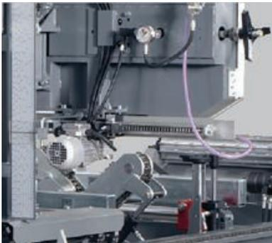
Per garantire la precisione del taglio, la puleggia di guida sul lato dell'operatore si avvicina il più possibile al pezzo da lavorare. Sistema di cuscinetti voluminosi azionato semplicemente. Può essere alimentato a motore e controllato come dispositivo ausiliario dal pannello di controllo.
