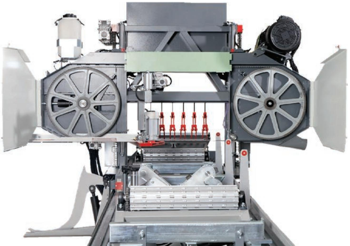
Il braccio è dotato di ruote a pale in ghisa grigia di alta qualità con un bilanciamento accurato contro le vibrazioni. La ruota ha una scanalatura lungo la sua circonferenza. La scanalatura contiene una cinghia in tessuto sostituibile che crea un'area di contatto ottimale tra la ruota e la lama della sega.
