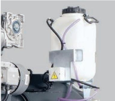
Il raffreddamento a gravità e la lubrificazione della fascia con prese regolabili su entrambe le pulegge di guida assicurano che la sega sia in condizioni ottimali durante il taglio.
